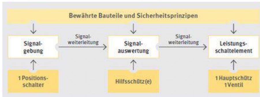
Zweikanalige Steuerungsstruktur für die Kategorien 3 und 4 nach DIN EN ISO 13849-1 für verriegelte trennende Schutzeinrichtungen
